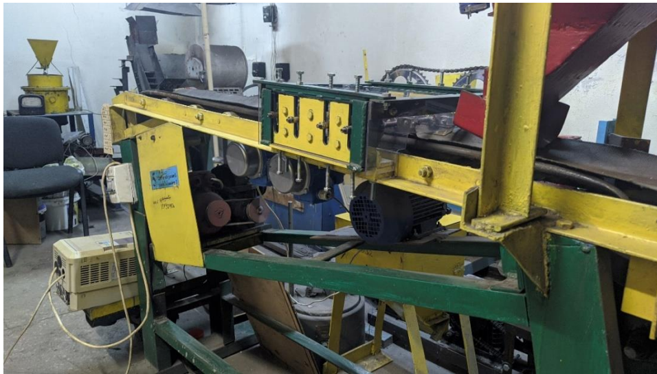
Рис 3.2 – Лабораторна модель технічної системи «роторний змішувач-конвеєр»
